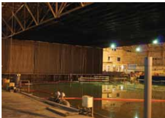
圖 1 水槽上方及左側方配置黑幕
