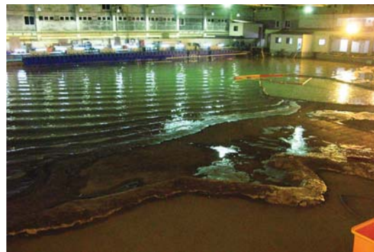
圖 2 平面水槽及造波設備
