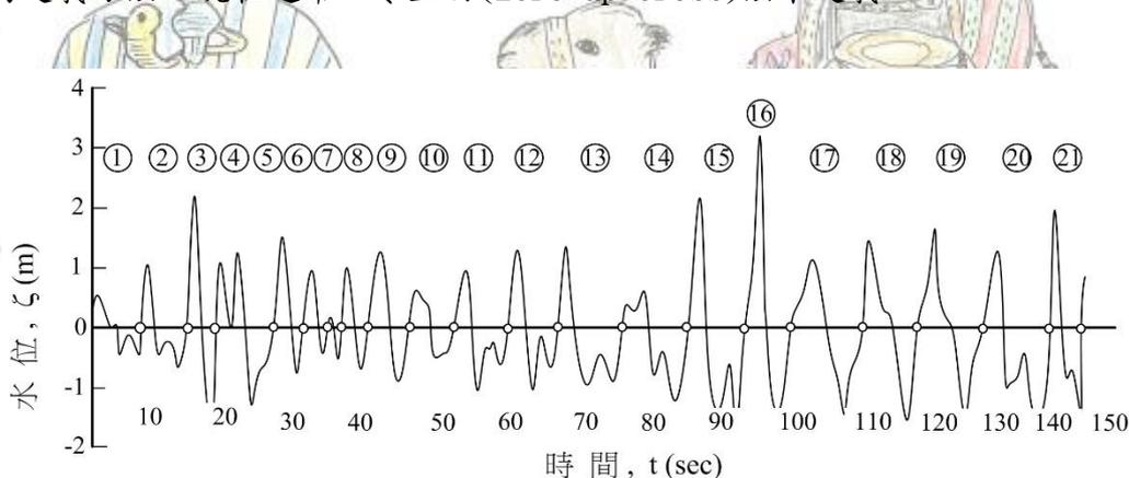
零上切法首先計算出水位的平均水位線，當波形從平均水位的負值側(即波谷)向平均水位線上升，在橫切平均水位線時作為一個波的開始，爾後波以不規則狀向上升至最高點後，再向下降低至零水位線以下，達最低點後會再逐漸上升而切平均水位線，此點為本波的終點(亦即稱下一個波的起點)。當橫座標軸為時間時，此兩點間間隔稱為該波的零上切週期，若座標軸表示距離即為零上切波長，同時在此區間內波形的最高點(波峰)與最低點(波谷間)的高程差稱為零上切波高，在此區間中雖有微小起伏(如第13、14波間)只要其不橫切零水位線即不予考慮，不規則波運動可參考波浪公式集數值模擬2維不規則波。
