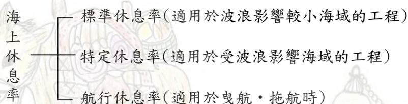
作業船舶適用海上休息率，在不同海象條件海域進行相關作業時，原則上採用主作業的休息率，但是副作業施工海域的休息率對工程作業有很大影響時，應適切檢討施工條件決定休息率。
